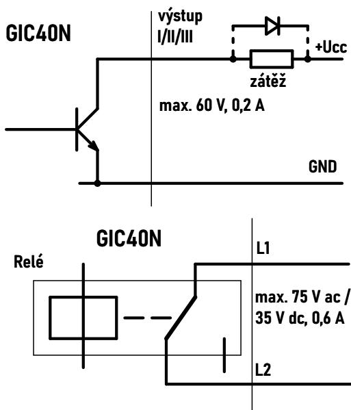
Na desce elektroniky jsou umístěny ještě 2 svorky poruchové smyčky. Spínacím prvkem je zde kontakt relé. U smyčky není nutné dodržet polaritu protékajícího proudu. Porucha (rozpojení L1 a L2) je signalizováno rozsvícením žluté kontrolky. Je-li detektor bez napájení je několik stovek milisekund po zapnutí smyčka ve stavu „porucha“ - tj. rozpojená.
