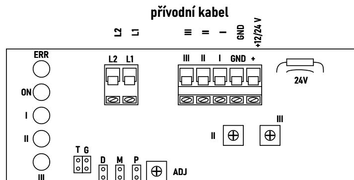
Trimry a propojky pro nastavení hlídané koncentrace plynu Nastavení úrovně hlídané koncentrace plynu pro jednotlivé stupně se provádí buď pomocí propojek T / G na pevně danou hodnotu nebo při nasazení propojky T pomocí trimrů. Hodnoty nastavené koncentrace určuje následující tabulka<sup>1</sup>:
