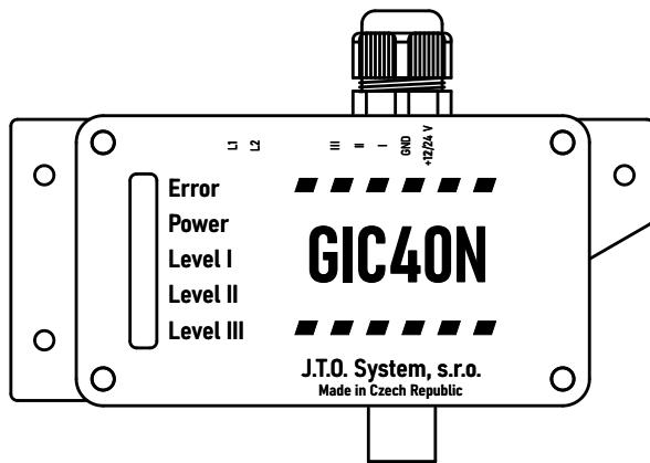
Úkolem detektoru je včasné vyslání signálu o vzniku potenciálně nebezpečné atmosféry pro zdraví. Pro svou činnost používají žhavené polovodičové čidlo, které může reagovat na přítomnost řady jiných hořlavých plynů nebo par. Speciálním postupem řízení čidla je ale dosaženo vysoké citlivosti na CO se sníženým vlivem jiných plynů.
