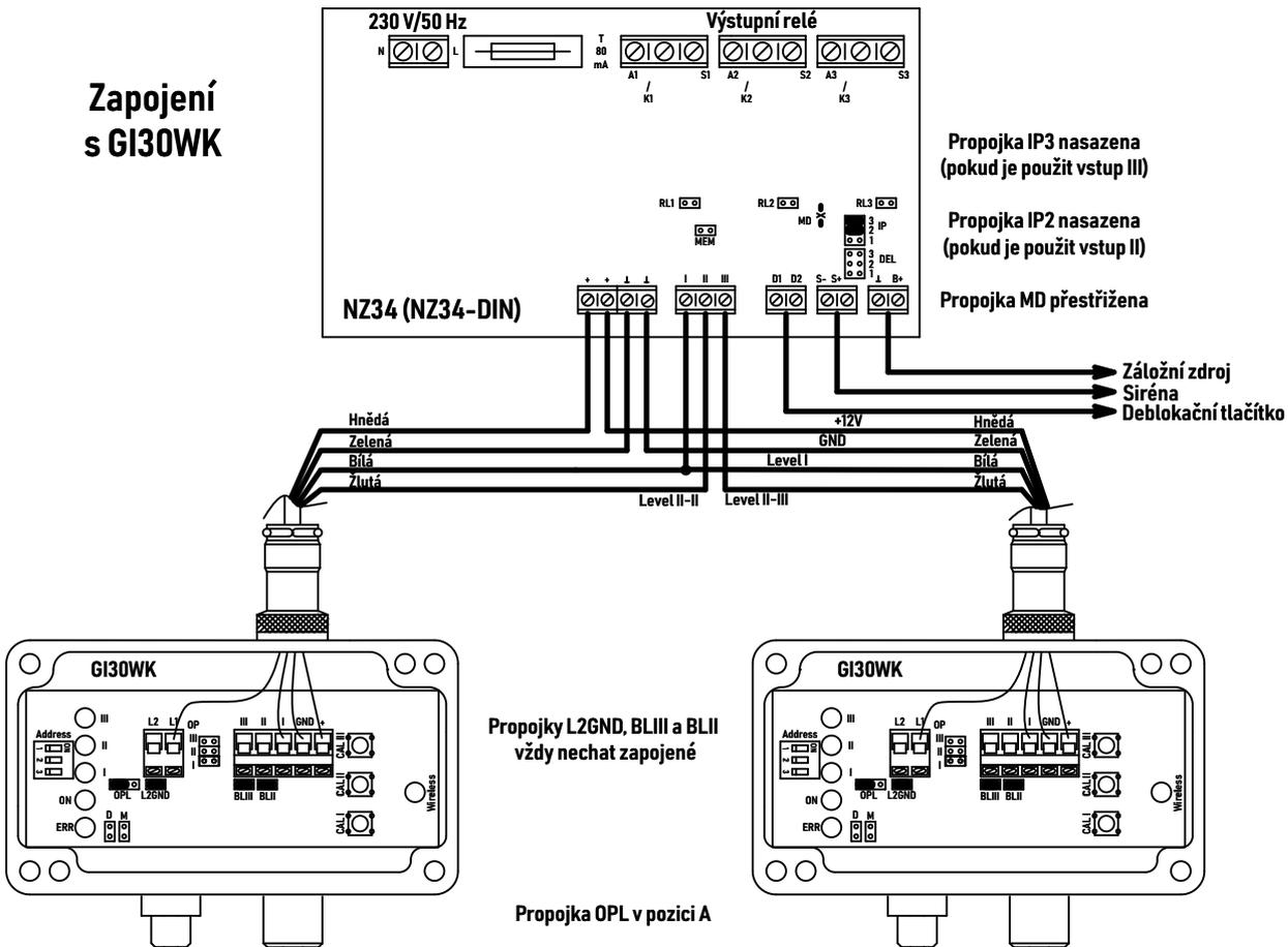
Každý z detektorů tak má zajištěnou samostatnou kontrolku ve zdroji pro signalizaci překročení druhého stupně koncentrace. Při této konfiguraci je doporučeno nastavit jak na zdroji, tak v detektorech opačný klidový stav výstupního signálu stupně II (v klidu sepnuto). Zbývající svorky napájecího zdroje NZ34 (NZ34-DIN) jsou zapojeny standardním způsobem. Výstupy relé je možné použít k ovládání akčních členů podle potřeb dané aplikace.
