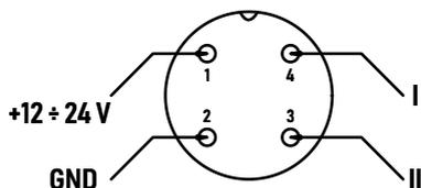
Pohled na vývody detektoru GI30WK (vývody ze strany kabelu).
