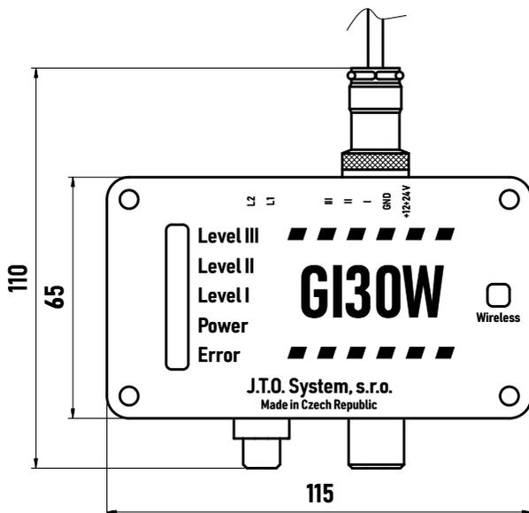
Úkolem detektoru je včasné vyslání signálu o vznikající potenciálně výbušné atmosféře. Pro svou činnost používá neselektivní žhavené polovodičové čidlo, které reaguje na přítomnost široké řady hořlavých plynů nebo par. Kalibrací pomocí požadované konkrétní hlídané látky se dosahuje přesného nastavení pro jednotlivé aplikace. Detektor GI30WK je možné nastavit na různé látky především uhlovodíkového charakteru jako např. vodík, metan, propan, butan, alkoholy, aceton apod.
