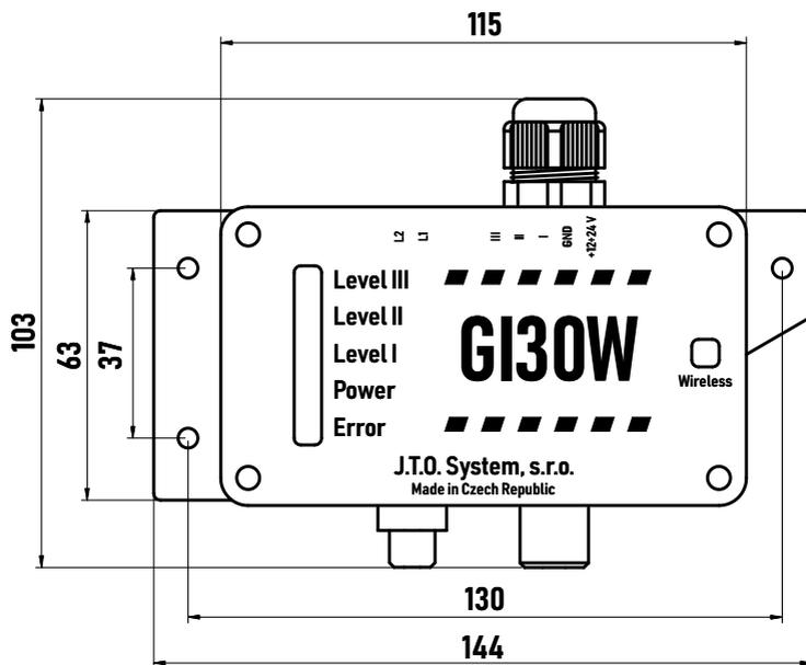
Úkolem detektoru je včasné vyslání signálu o vznikající potenciálně výbušné atmosféře. Pro svou činnost používá neselektivní žhavené polovodičové čidlo, které reaguje na přítomnost široké řady hořlavých plynů nebo par. Kalibrací pomocí požadované konkrétní hlídané látky se dosahuje přesného nastavení pro jednotlivé aplikace. Detektor GI30WN je možné nastavit na různé látky především uhlovodíkového charakteru jako např. vodík, metan, propan, butan, alkoholy, aceton apod.
