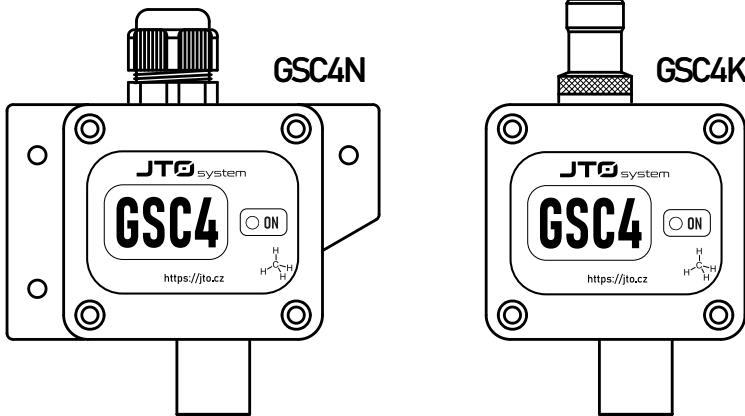
Úkolem snímače je kontinuální monitorování koncentrace hořlavých plynů nebo par v ovzduší. Pro svou činnost používá neselektivní katalytické čidlo, které reaguje na přítomnost široké řady hořlavých plynů nebo par. Kalibrací pomocí požadované konkrétní hlídané látky (např. vodík, metan, propan, butan, alkoholy, aceton apod.) se dosahuje přesného nastavení pro jednotlivé aplikace.
